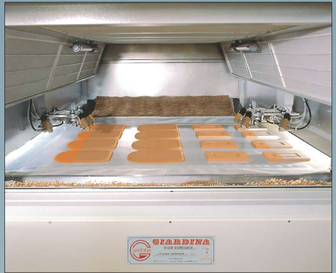
Fig.B) Il tappeto con larghezza di 1800 mm consente di raccogliere la quasi totalità della vernice spruzzata ma non depositatasi sui pezzi, riducendo notevolmente la quantità di vernice da aspirare e da abbattere.
